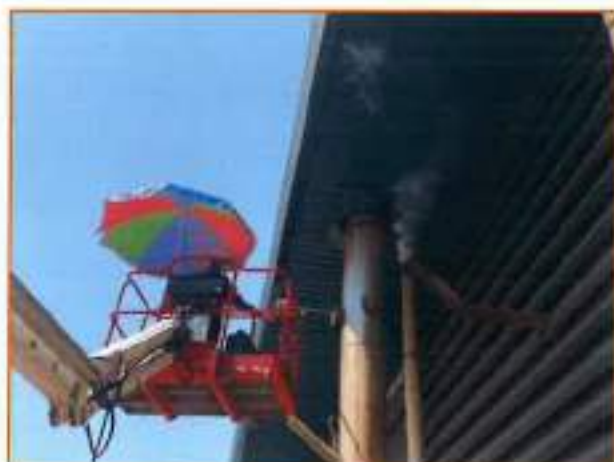
รูปที่ 1 การตรวจวัดปริมาณ Total suspended particulate (TSP), Sulfur dioxide (SO 2 ), Oxides of Nitrogen (NO x ) และ Carbon monoxide (CO) จากปล่องระบาย Boiler
