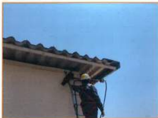
รูปที่ 4 การตรวจวัดปริมาณ Total suspended particulate (TSP), Sulfur dioxide (SO 2 ), Oxides of Nitrogen (NO x ) และ Carbon monoxide (CO) จากปล่องระบาย Fire Pump
